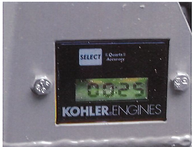
Tachyhoramètre (compte-tours avec heures de fonctionnement)
